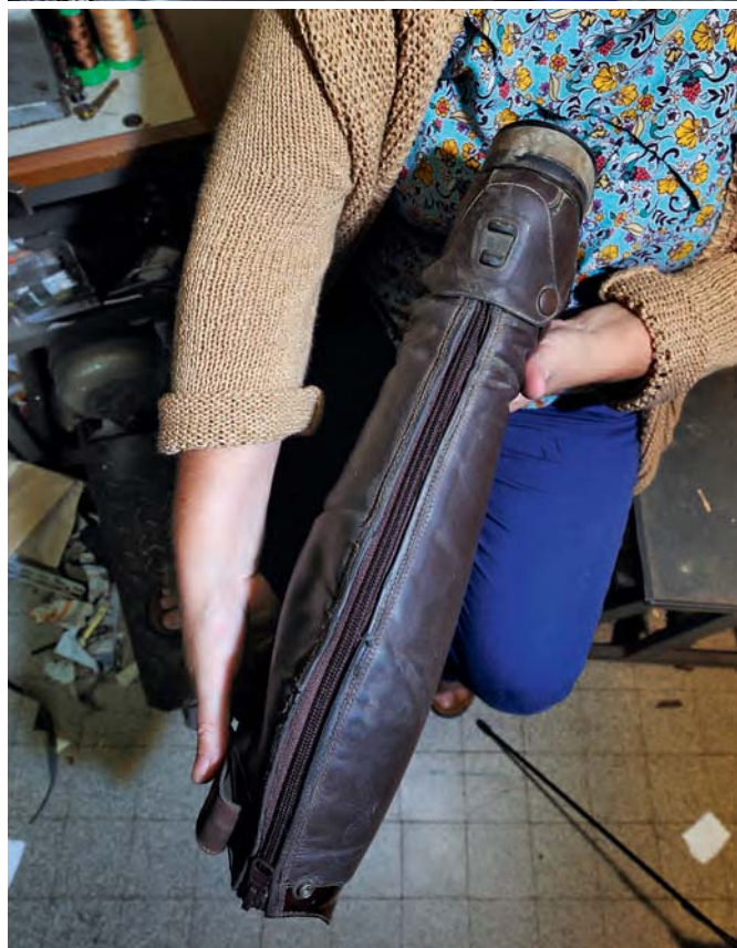
Travail fini de la pose de la fermeture.
